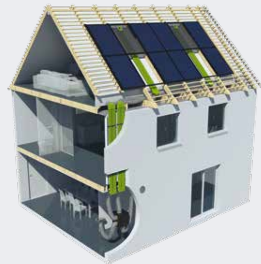
Intégration en local technique dans une maison à étage (r+1) avec combles aménagés
